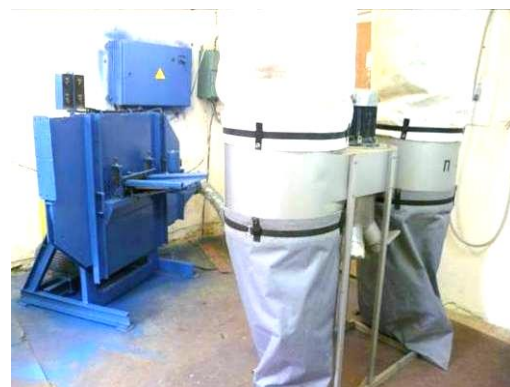
Рис. 2. Усовершенствованный экспериментальный образец МПЛ с двумя рабочими органами, осуществляющими двухстороннее воздействие и системой удаления, разгрузки и очистки воздуха в промышленном фильтре: а – вид с фронта (со стороны входа лубяных культур); б – вид с системой разгрузки волокна и очистки воздуха:
