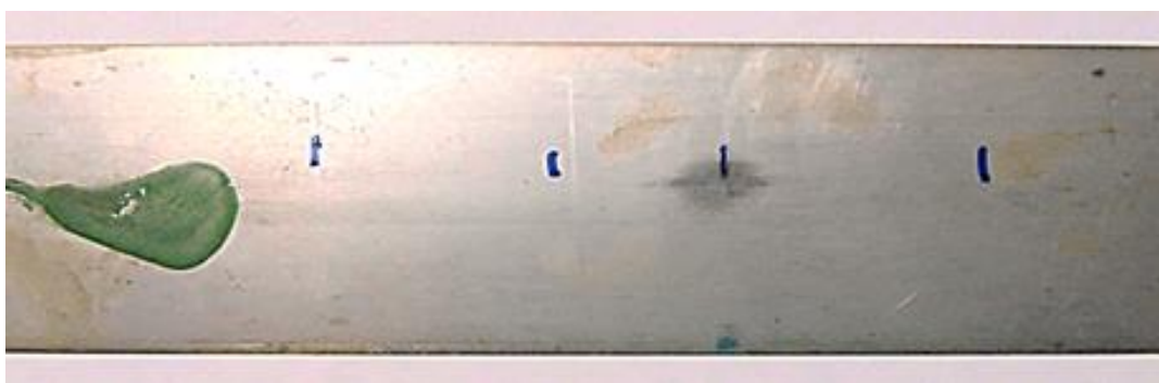
Рис. 6. Стальная пластина уточного тормоза, работавшая с ситалловой накладкой предлагаемой формы 560 час.
