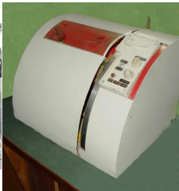
Рис. 13. Серийно выпускаемое средство контроля – «Волоконпрокалыватель лабораторный ВЛ»
