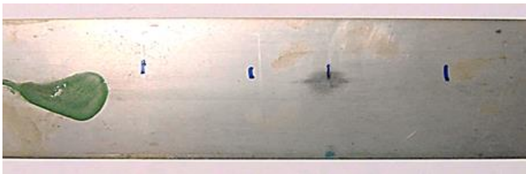
Рис. 4. Стальная пластина уточного тормоза, работавшая с ситалловой накладкой новой формы 48 час
