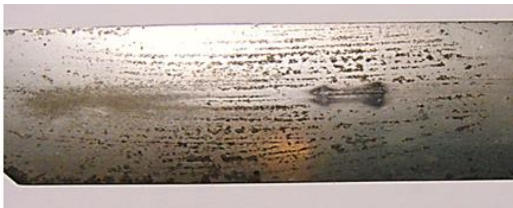
Рис. 5. Стальная пластина уточного тормоза, работавшая с ситалловой накладкой стандартной формы 560 час.
