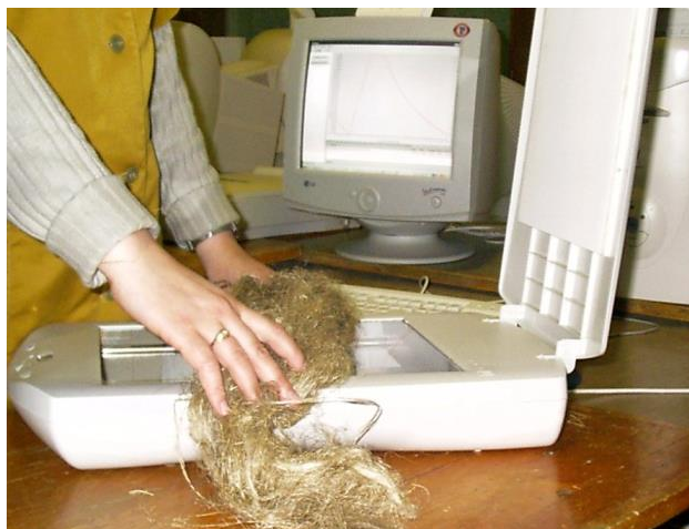
Рис. 21. Определение параметров цвета волокна с использованием сканера
