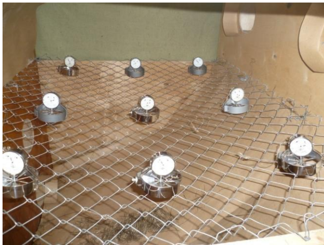
Рис. 2. Вид установки анемометров на сетке-рабице в сушильной камере
