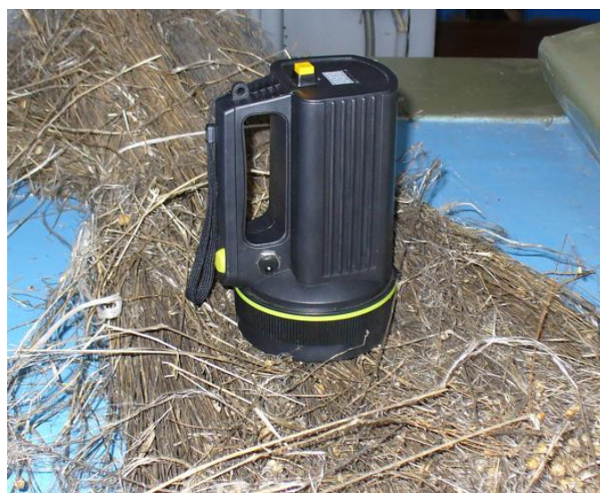
Рис. 23. Внешний вид универсального средства контроля цвета тресты (волокна) и степени вылежки льна (ОВЛ) А) – пластмассовый; Б) - металлический корпус
